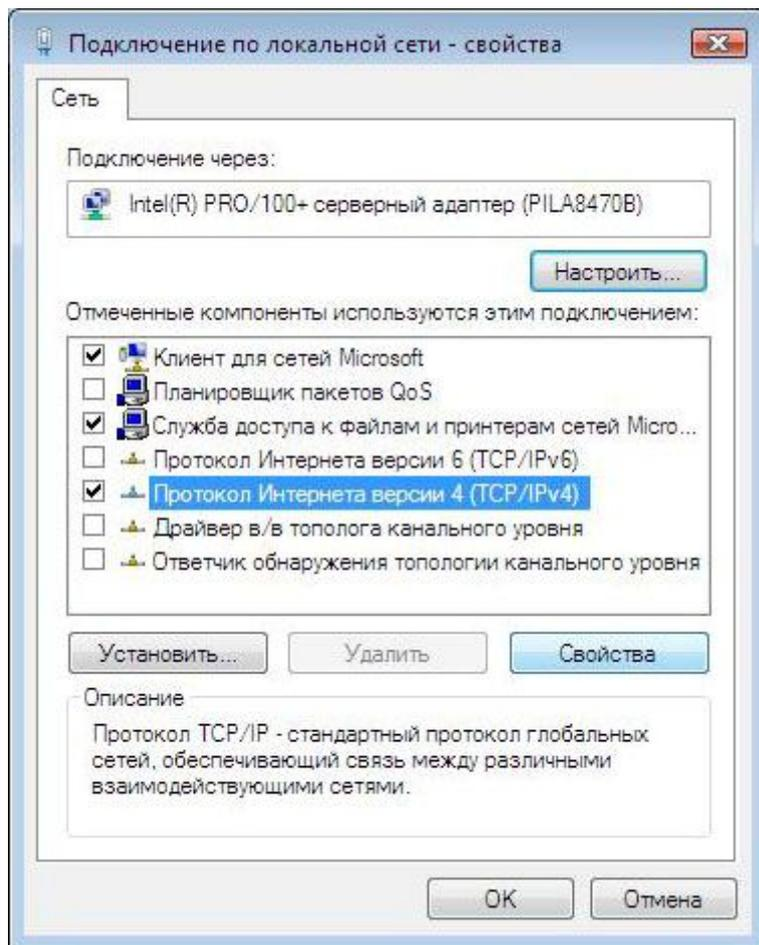
**Шаг 6. Появляется окно конфигурации протокола TCP/IPv4. Выбираете Использовать следующий IP-адрес и Использовать следующие адреса DNS-серверов.**
